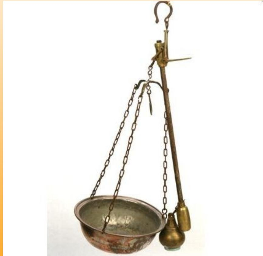
Utilizar la balanza (indicando que ésta no pesa, sino que compara)
